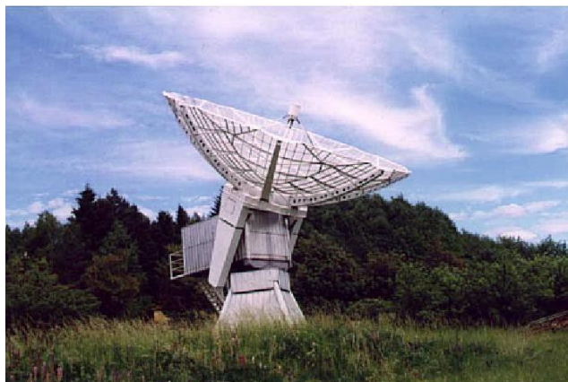
Obr. 6: Radioteleskop RT5 na Astronomickém ústavu AVČR v Ondřejově. Bezmála desetimetrová anténa na samočinné azimutální montáži napájí sluneční radiový spektrograf v pásmu 800 MHz - 2 GHz.
