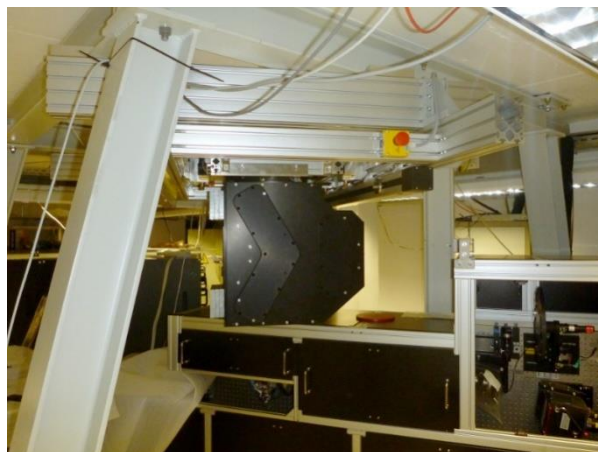
Obr. 5. Rotátor obrazu pod výstupem z dalekohledu. Vpravo je vidět část optické lavice s adaptivní optikou.
