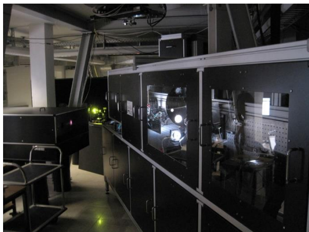
Obr. 4. Optická laboratoř se systémem adaptivní optiky pod výstupem z dalekohledu (ještě bez rotátoru obrazu).
