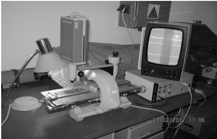
Obr.7 TV – Abbe komparátor na meranie presných polôh spektrálnych čiar
