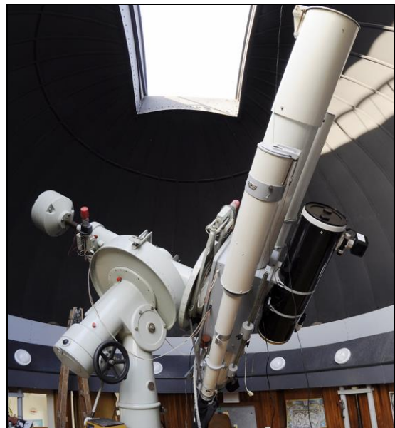
Obr. č. 1. Pohled na systém dalekohledů v kopuli odborného pracoviště. Ve spodní části soustavy je umístěn protuberanční koronograf s Šolcovým H \alpha filtrem.
