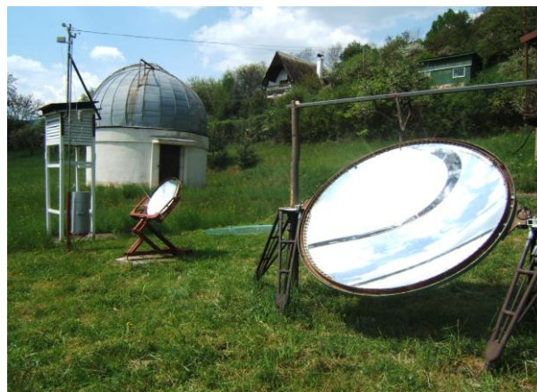
Obr. 1. Veľká (v popredí) a malá slnečná pec
