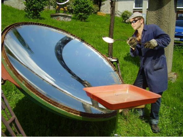
Obr. 7. Tavba zliatiny olova v ohnisku pece SF 2
